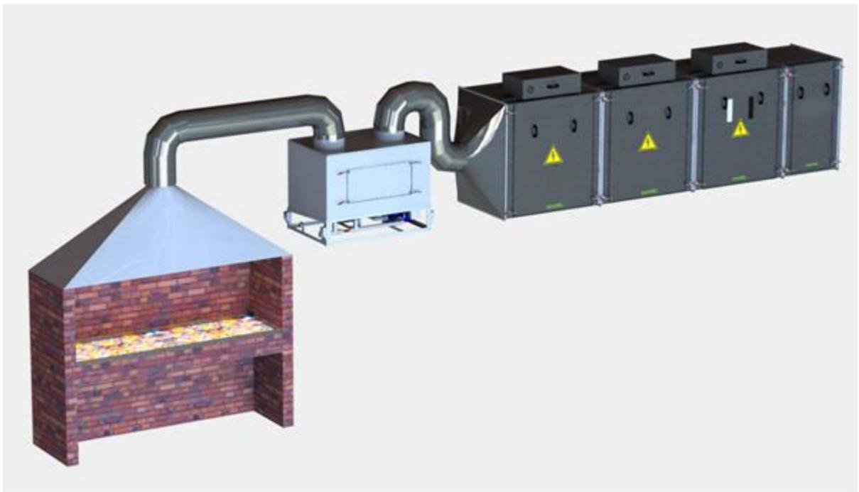
Рисунок А.4 – Общая схема подключения гидрофильтра и системы очистки дымовых газов к воздуховоду
